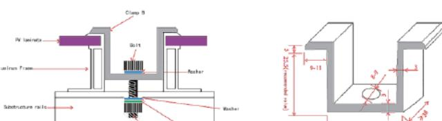
Schéma upevnění (jednotka: mm)
